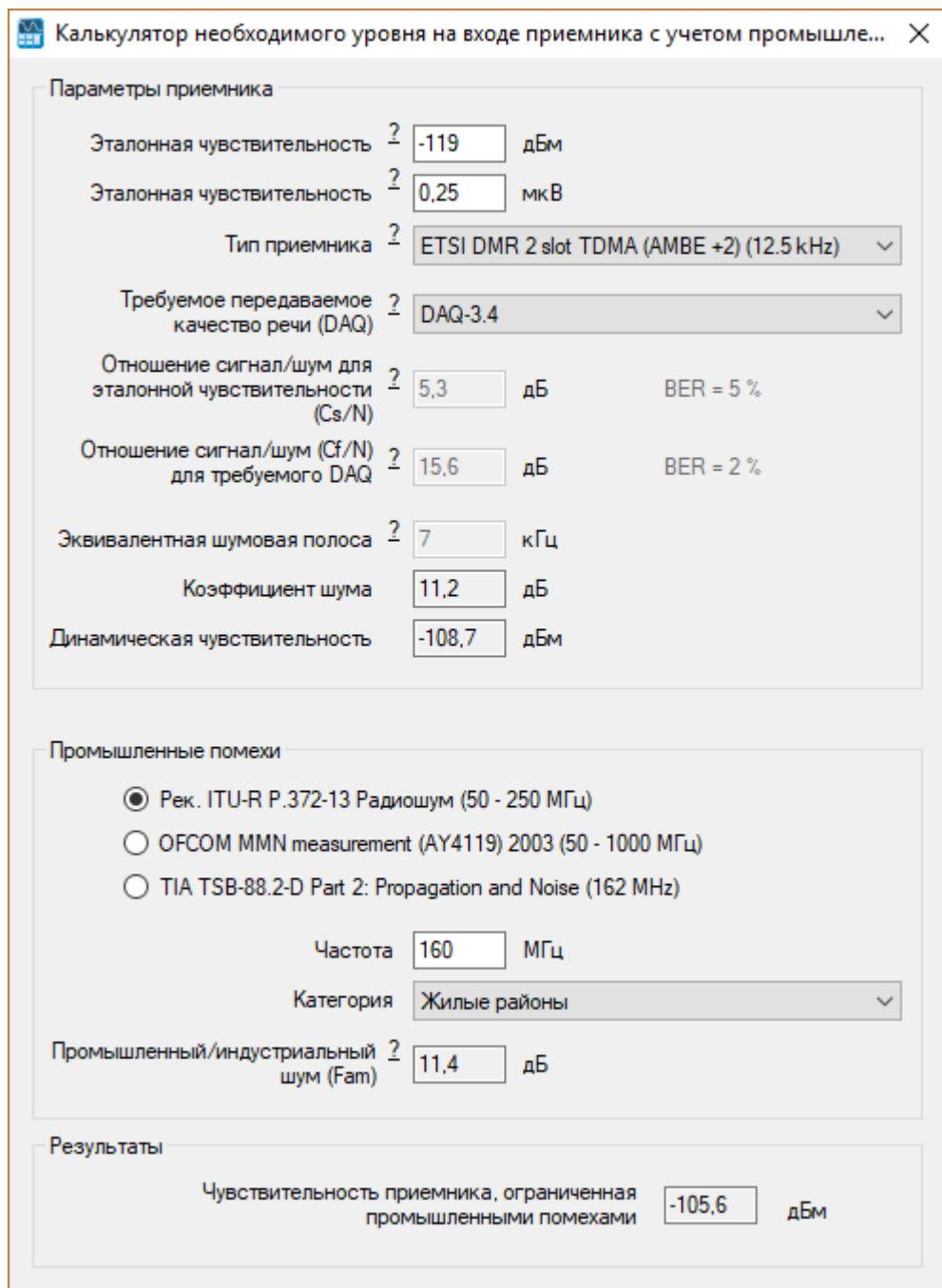
Рисунок 42. Калькулятор промышленных радиопомех
