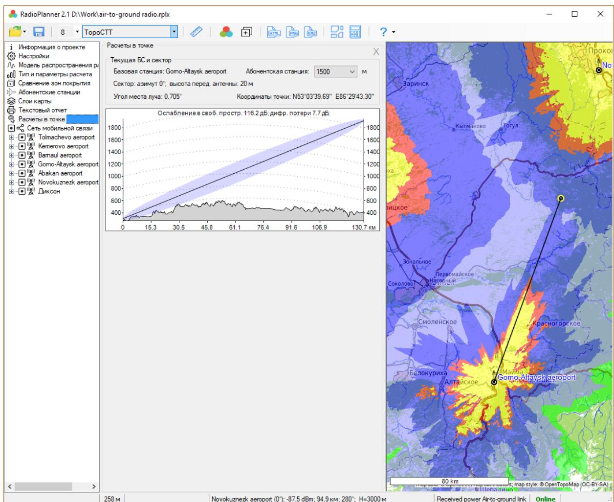
Рисунок 60. Расчеты в точке для авиационной радиосвязи
