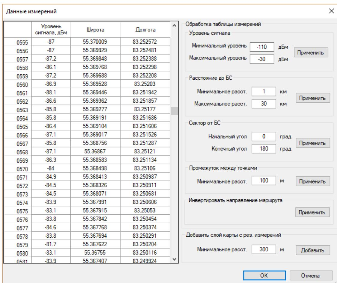
Рисунок 39. Предварительная обработка результатов измерений в секторе БС
