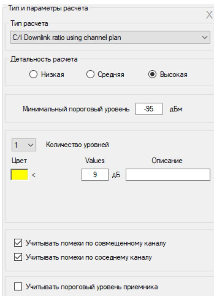
Рисунок 30. Параметры расчета радиопокрытия для С/I на входе приемника АС
