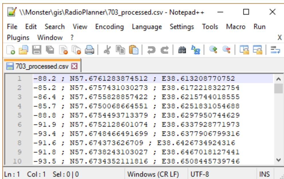
Рисунок 54. Универсальный файл измерений в формате CSV
