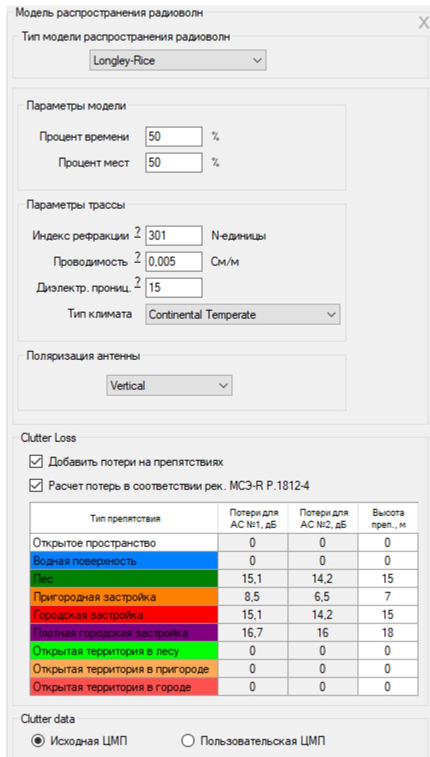
Рисунок 26. Параметры модели Лонгли-Райса
