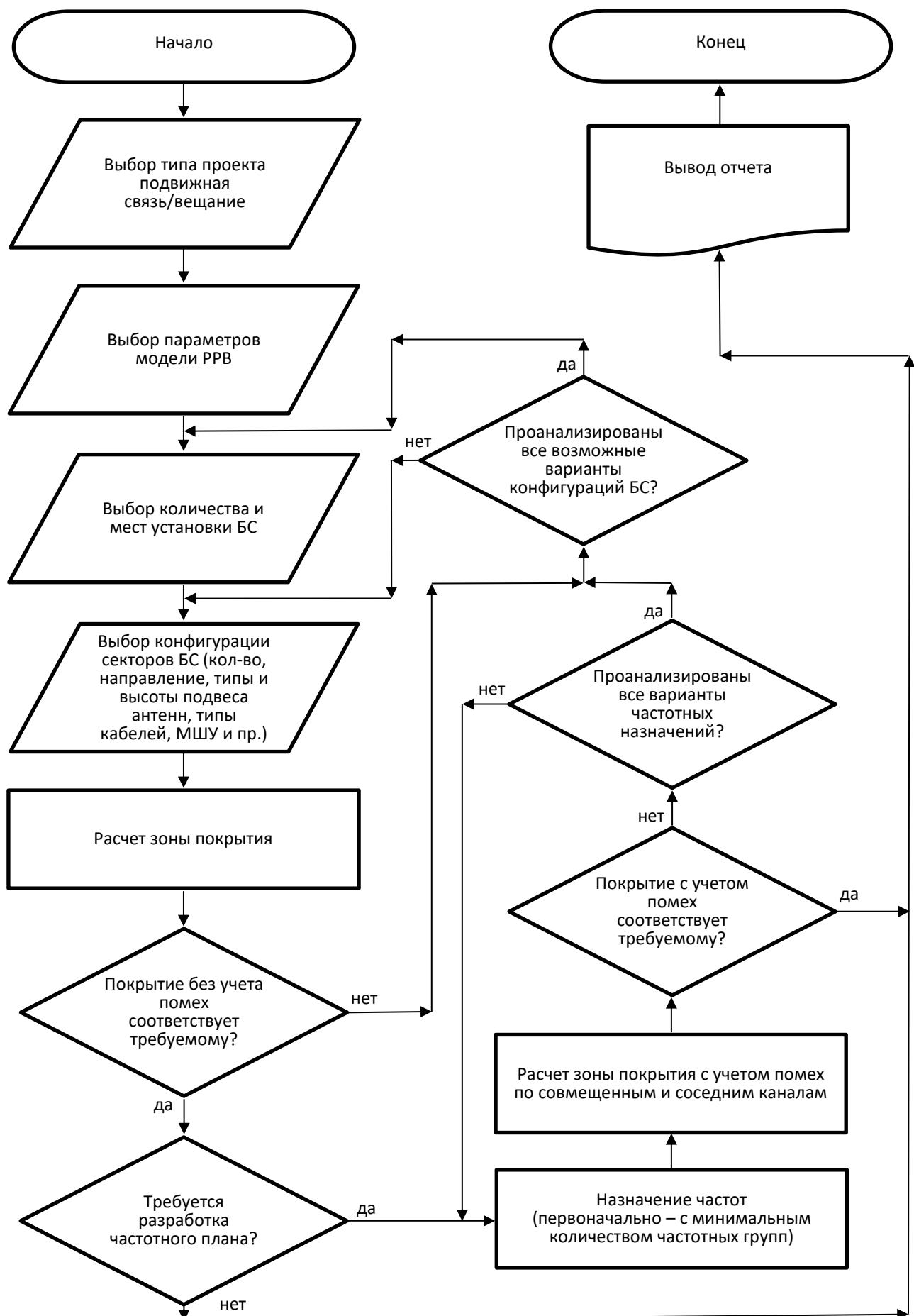
Рисунок 15. Общая блок-схема алгоритма работы с программой RadioPlanner
