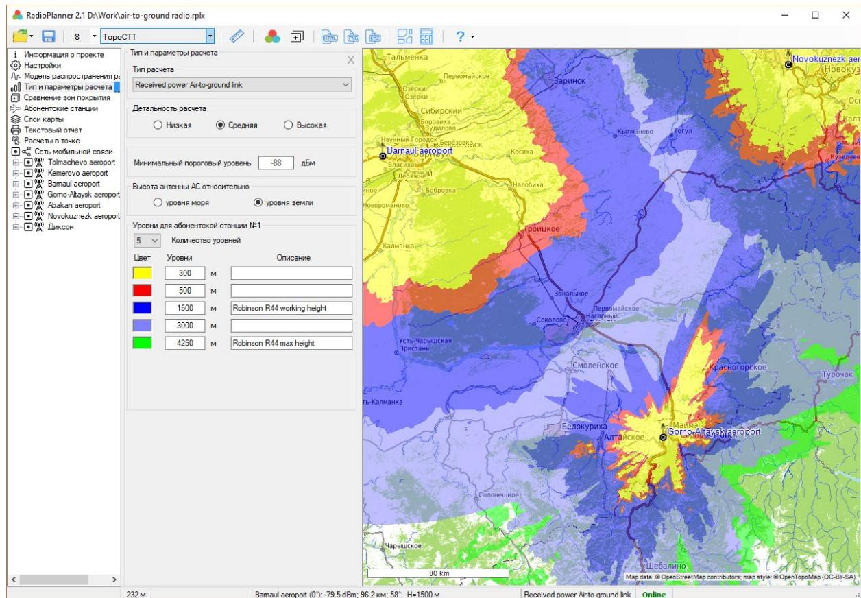
Рисунок 57. Пример расчета для зоны покрытия для малой авиации
