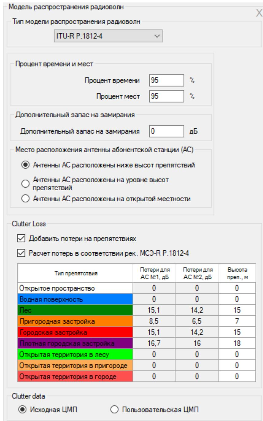
Рисунок 24. Параметры модели МСЭ-R P.1812-4
