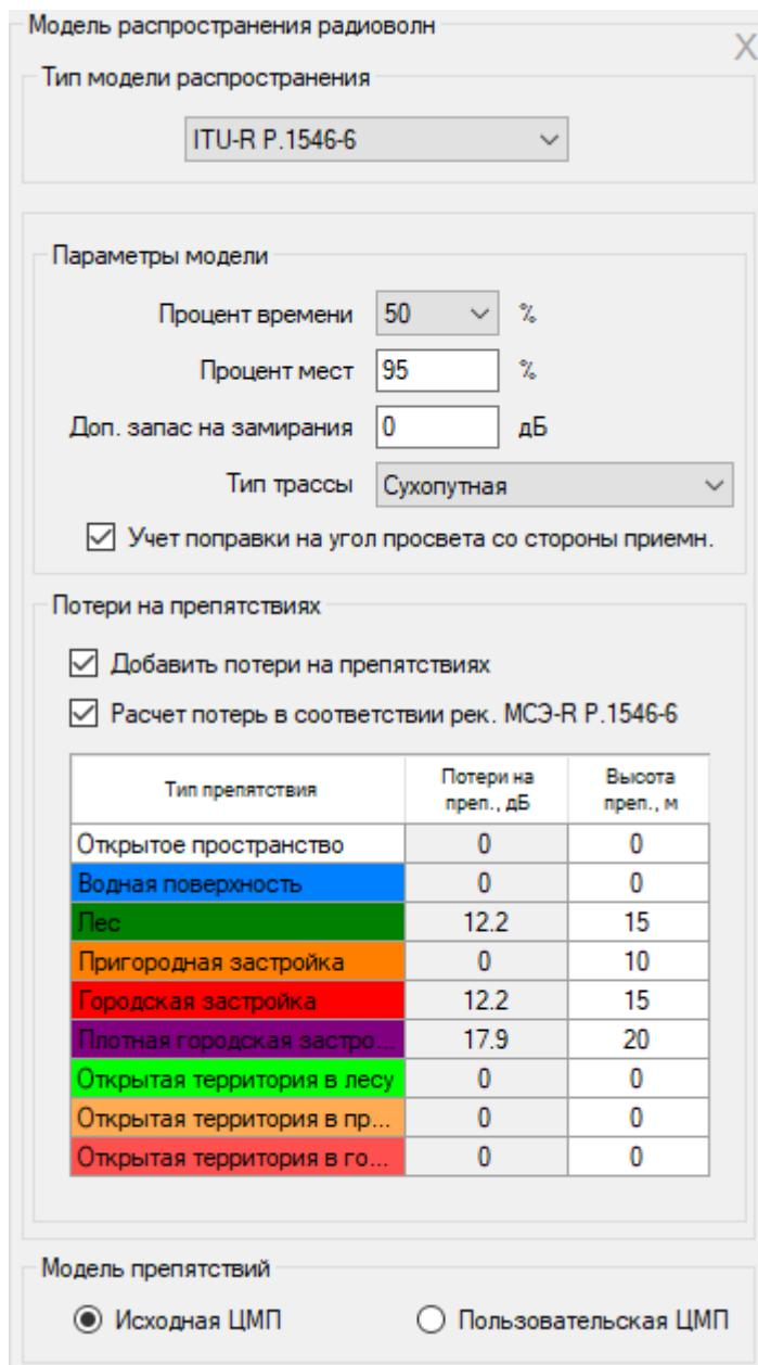
Рисунок 46. Параметры модели МСЭ-R P.1546-6
